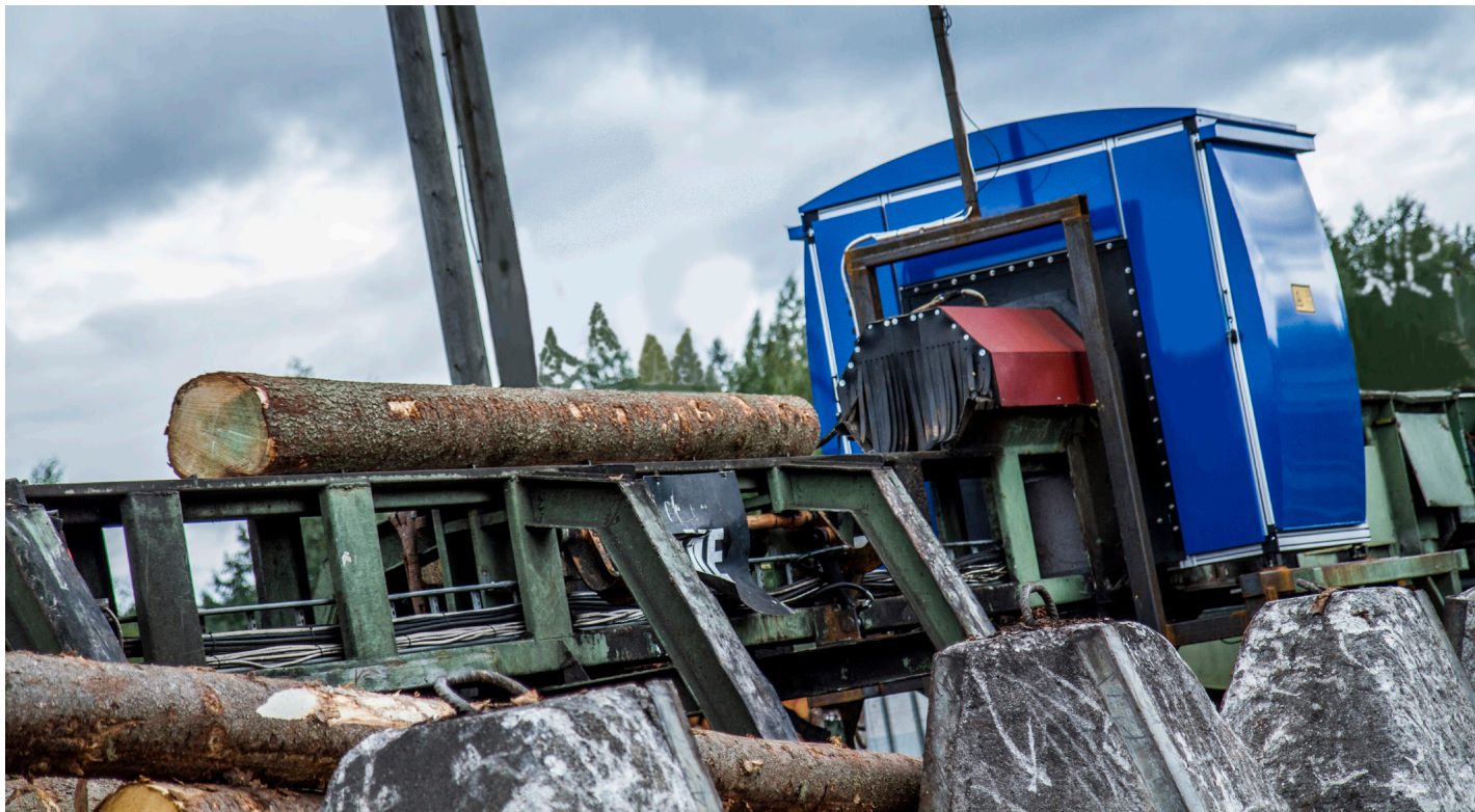
RemaSawcos produkt RS-LogProfiler3DX matar in timmerstockar för 3D- och röntgenskanning.
